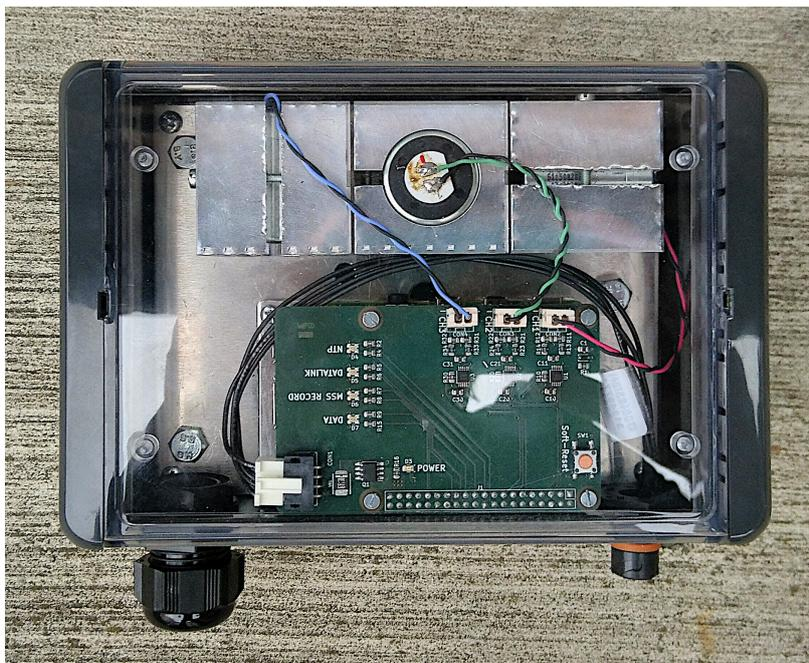
Abbildung 37: MSS-2. Der transparente Deckel ermöglicht die Sicht auf vier LEDs, die den Status des MSS anzeigen. Als Gehäuse wird ein industriell gefertigtes, leicht verfügbares Produkt verwendet. Der Stromstecker ist ein robuster, verriegelbarer Steckverbinder. Das Ethernetkabel hat eine Zugentlastung.
